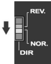
Para la verificación del sentido de actuación del giro, el GY 401 debe funcionar como un giro convencional. Para esto, activar en el emisor el modo normal (ver página 8). Sobreelevar el helicóptero y girarle brutalmente alrededor del eje vertical hacia la izquierda, el giro debe comandar las palas del rotor trasero según el croquis.
