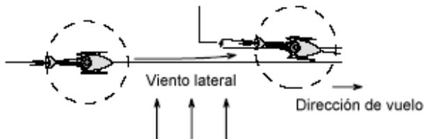
Cuando el helicóptero vuela con un viento de lado, la cola está desplazada por la fuerza del viento. Un giróscopo convencional detiene esta deriva por las señales apropiadas al servo antipar.
