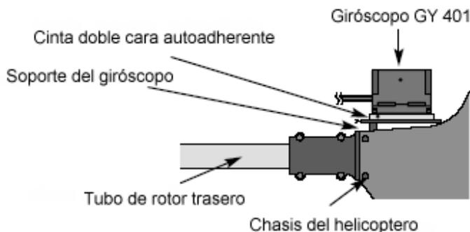
Instalar el giróscopo de tal suerte que el eje del rotor principal sea perfectamente perpendicular al fondo de la caja del giróscopo.
